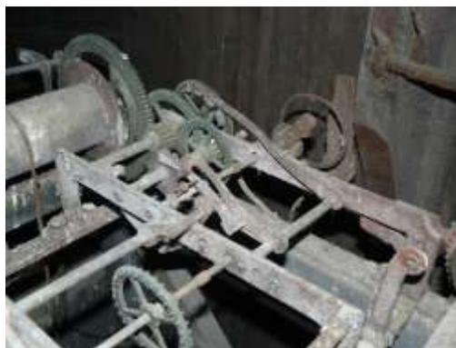
Le mécanisme de commande des aiguilles et du marteau pour sonner les heures
